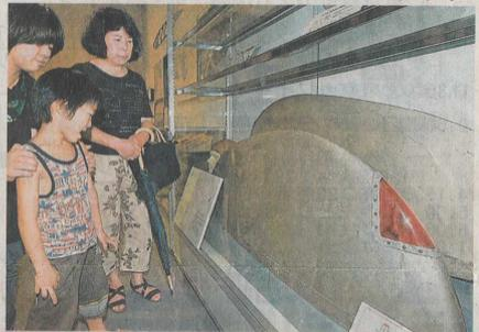
旧海軍陸上爆撃機「銀河」 計画ではゼロ戦並みの最高速度で、800kg～1トンの爆弾を搭載できた。当時としては優れた性能だったが、戦況は既に芳しくなく、大きな戦果は挙げられなかった。全長15m、全幅20m、約1千機が製作され、マリアナ沖海戦、沖縄戦、本土防空戦などに投入された。
